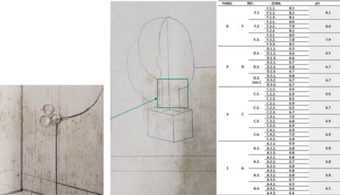
[F. 13] Mediciones de pH con discos de agarosa en uno de los paneles previo al tratamiento de intervención.
