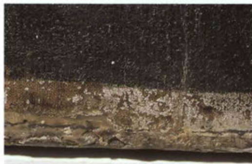
Fot. n.º 117. Estado actual. Pliegue producido por enrollamiento, con pérdidas de pintura.
