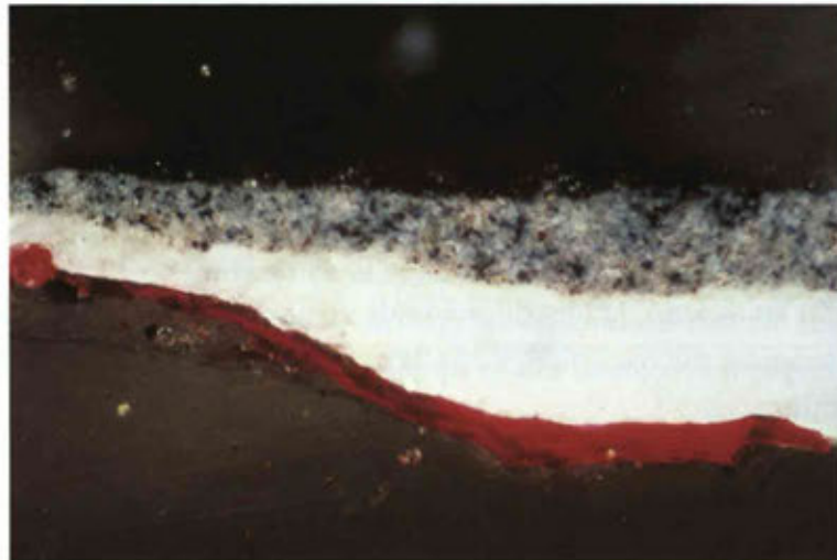
M 1 . Microfotografía de la muestra anterior, teñida con el reactivo Fuchsin. La fuerte tinción roja es indicativa de la naturaleza proteica de esta capa. En concreto, refleja la existencia de cola animal.
