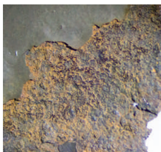
[F. 08] Detalle del antes y después de la aplicación del ácido tánico en el soporte metálico.
