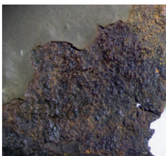
[F. 08] Detalle del antes y después de la aplicación del ácido tánico en el soporte metálico.
